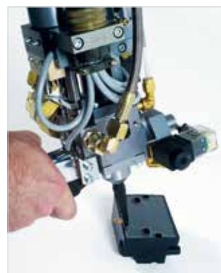
Manueller Auftrag von Vergussmasse mit dem SONDERHOFF MK 50
