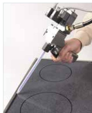
Manuelle Versiegelung mit dem SONDERHOFF MK 20
