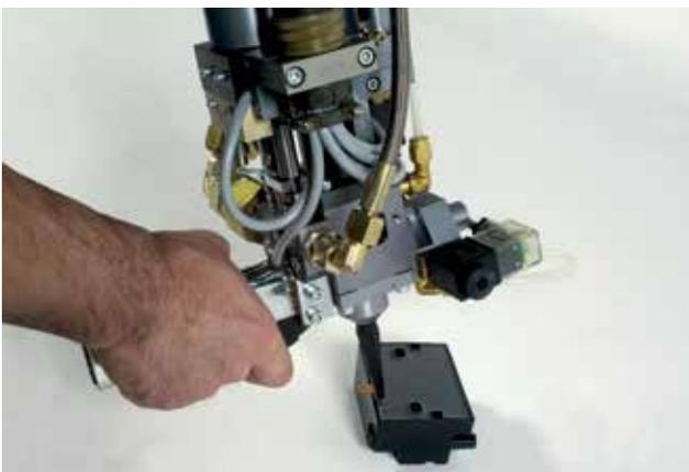
Manueller Verguß von einem Elektronikbauteil mit dem MK 50 und zweikomponenten FERMADUR® Gießharz
