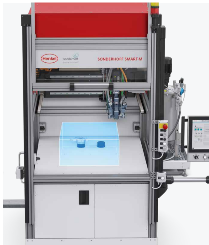
Verfahrbereich in der Dosierzelle SONDERHOFF SMART-M: 500 x 600 x 250 mm (x/y/z)
