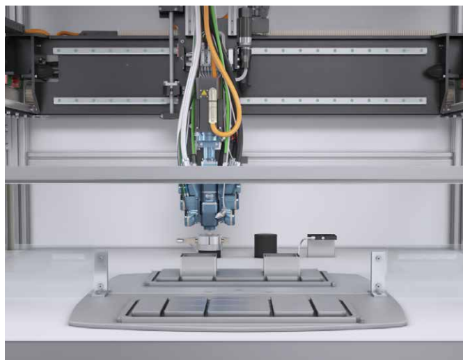
Mischkopf beim Füllschuss in die AIR-CLEAN Einheit
