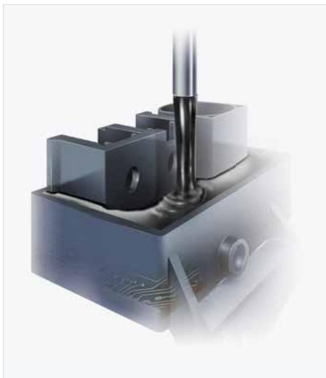
Dimensionsgenaues Vergießen von PU-Verguss mit dem CNC-gesteuerten Mischkopf der Misch- und Dosieranlage DM 502
