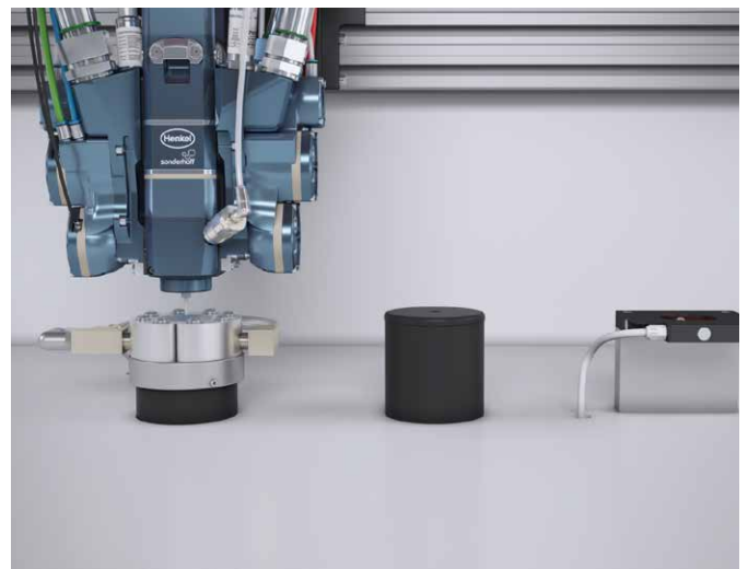
Links: Die pneumatische AIR-CLEAN Düsenreinigung reinigt die Mischkopfdüse mittels Druckluft. Mitte: Vorrichtung für die Hochdruckwasserspülung und Füllschussstation. Rechts: Die laserbasierte Düsenvermessungseinheit NOZZLE-CONTROL überprüft die korrekte Lage der Dosierdüse und Verschmutzungen.
