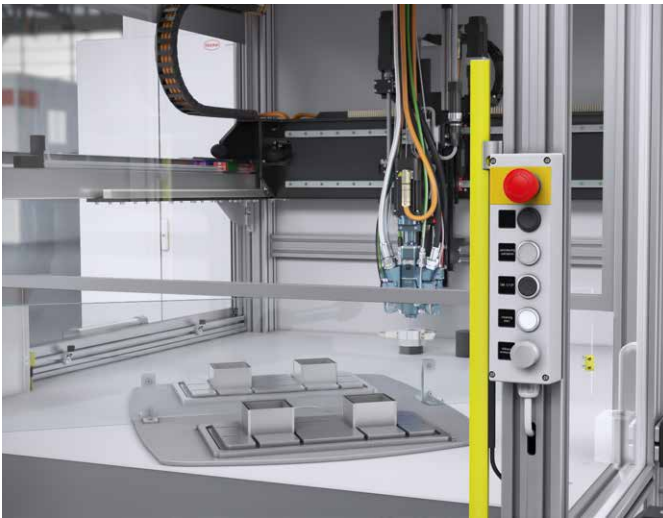
Rundtaktisch dreht um 180° in die Dosierposition zum konturgenauen Abfahren des Bauteils für den Materialauftrag
