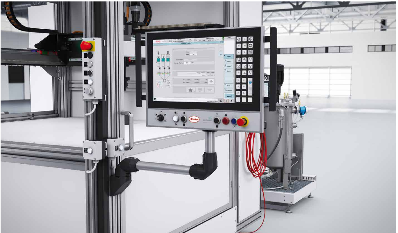
Optional: Multitouch-Bedienpanel CONTROL 2, seitlich an einem Schwenkarm montiert, mit Anzeigeelementen und Bedientasten, Visualisierung über 21,5" Touchscreen. Bei der Option erhalten Sie zusätzlich das multifunktionale Mobile Panel MP 2.
