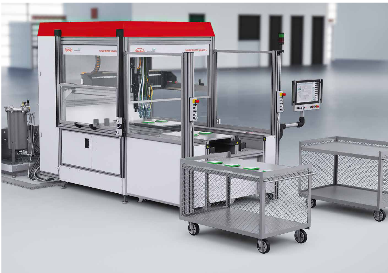
Dosierzelle SMART-L mit Hordenwagen für Pick&Place-Bestückung und Ablage der fertigen Bauteile
