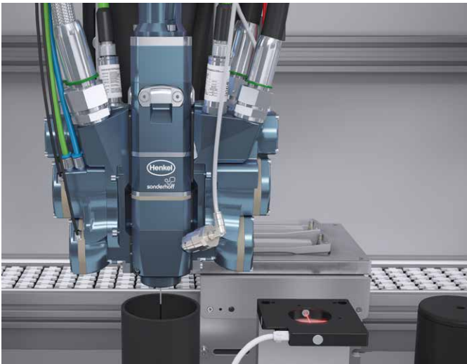
Der Mischkopf MK 800 PRO befindet sich in der Füllschussposition.
