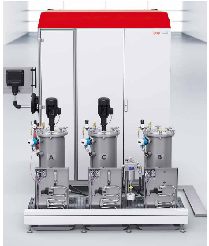
In der Zellenrückseite integrierter Dosiermaschinenschrank mit Flügeltüren und Materialdruckbehälter (24 l oder 44 l, einwandig oder doppelwandig) auf Gitterrostpodest mit einstellbaren Nivellierfüßen und Auffangwanne
