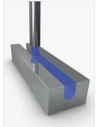
Gel dosing, deep groove
