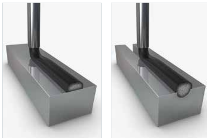
Der Dosierauftrag kann auf ebener Fläche oder in einer Nut erfolgen.
