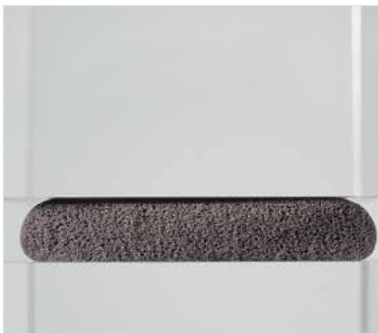
Querschnitt Polyurethanschaumraupe zu 50 % verpresst
