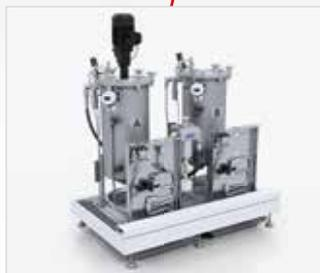
Separat stehende **Materialdruckbehälter** (24 l oder 44 l, einwandig oder doppelwandig) mit Minimum-Füllstandsensoren, auf Gitterrostpodest mit einstellbaren Nivellierfüßen und Auffangwanne
