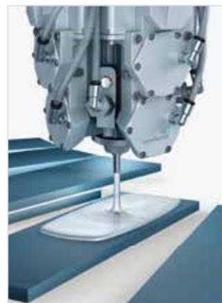
Klebdichtstoff FERMAPOR K31 für die Rahmenverklebung von Filterpaketen
