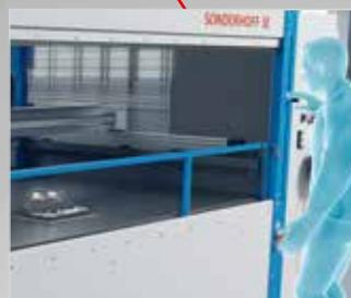
Die manuelle **Hubtür** bzw. das optional bestellbare Schnellaufstor grenzen den Verfahrbereich des Linearroboters zum Bediener sicher ab.
