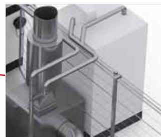
Optional: **Primerabsaugstation** für eine fachgerechte Luftreinigung an der Maschine bei Einsatz lösemittelbasierter Primer
