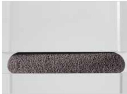
Querschnitt Polyurethanschaumraupe zu 50 % verpresst
