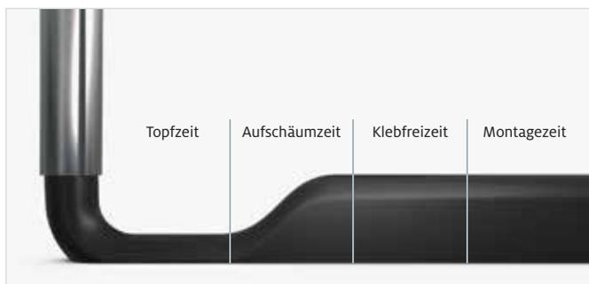
Die verschiedenen Reaktionsphasen des Dichtungsschums in der zeitlichen Abfolge
