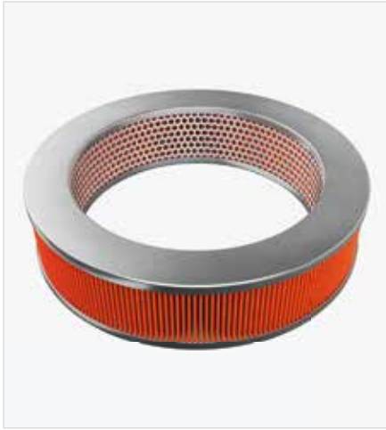
Radial-Luftfilter mit verklebten Endkappen
