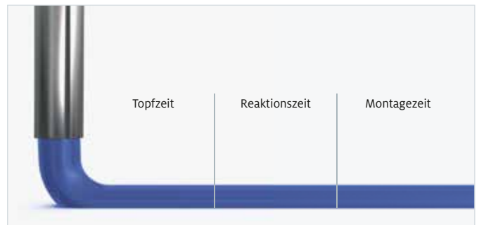
Die verschiedenen Reaktionsphasen des Polyurethan-Gels in der zeitlichen Abfolge
