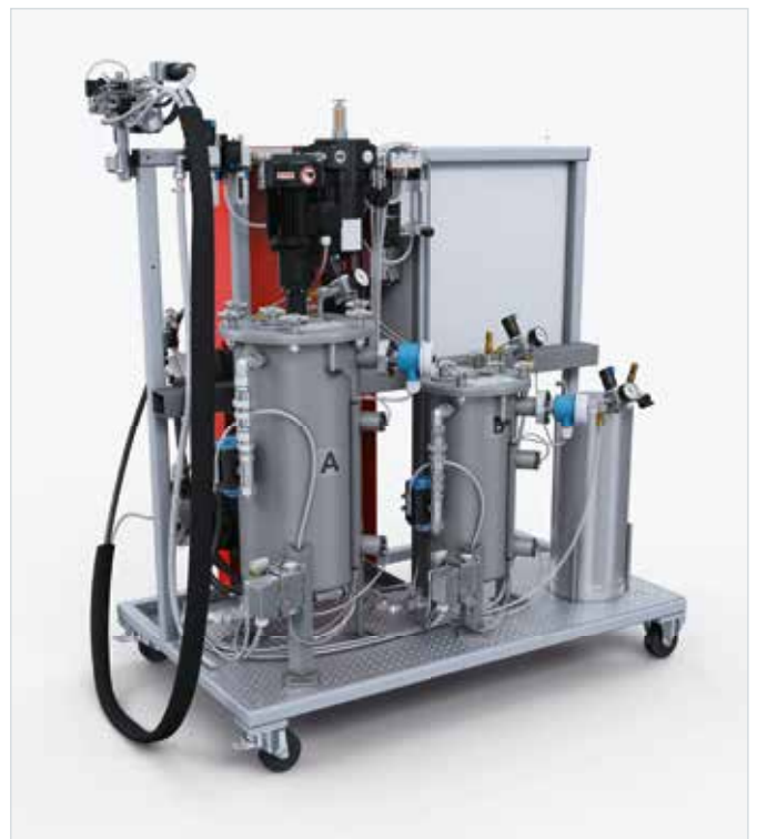
Misch- und Dosiermaschine DM 70 COMPACT mit Materialdruckbehältern (24 l oder 44 l), ausgestattet mit Minimum-Füllstandsensoren und zusätzlichem Druckbehälter für Mischkopf-Reinigungsmittel
