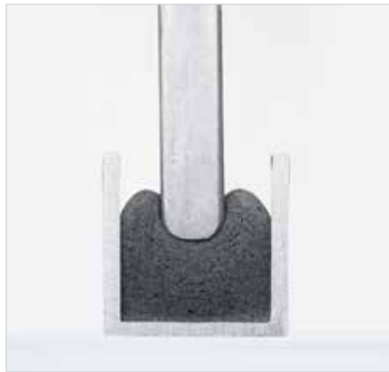
Querschnitt Polyurethanschaumraupe in Nut zu ca. 50 % verpresst
