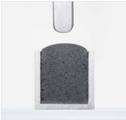
Querschnitt Polyurethanschaumraupe in Nut unverpresst
