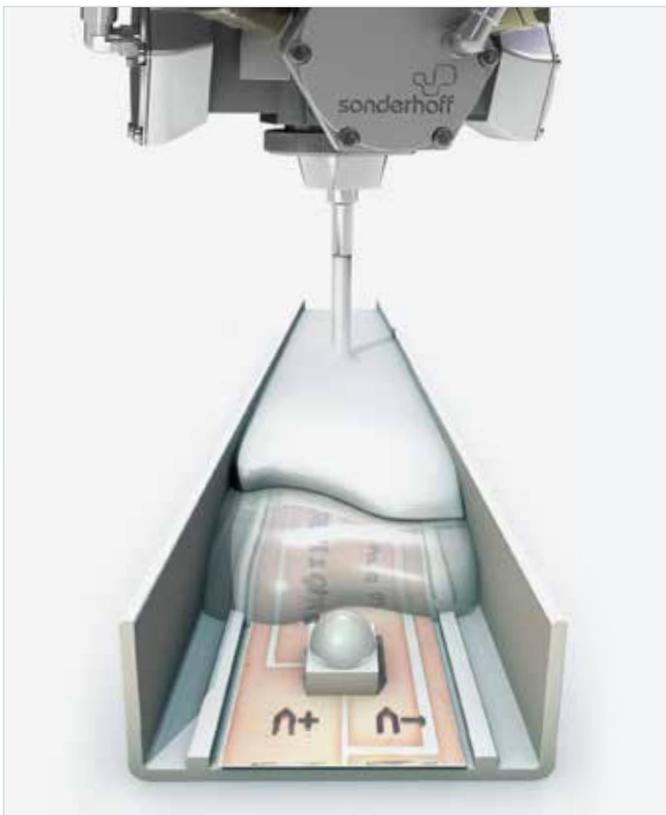
Für die vollflächig vergossenen LEDs stehen Ihnen unsere Polyurethan-Vergussysteme in transparenter oder zur besseren Lichtstreuung in opaker Ausführung zur Verfügung. Die hohe UV-Beständigkeit unserer aliphatischen Klarvergussysteme ermöglicht eine höhere Lichtdurchlässigkeit als von transparenten Kunststoffabdeckungen, die leicht verkratzen können. Auch bei einem 40-Tage-Dauertest bei +150 °C bleibt noch eine Lichtdurchlässigkeit von ca. 90 % der transparenten Vergussysteme bestehen.
