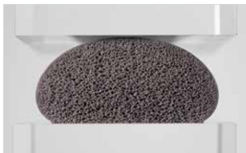
Die unverpresste Polyurethan-Schaumdichtung vor dem Einbau.
