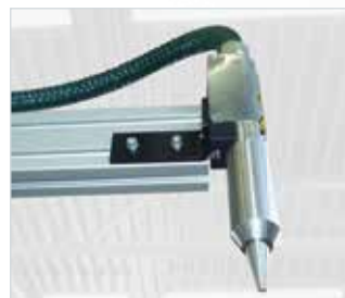
Oberflächenaktivierung durch Atmosphärenplasma zur Verbesserung der Haftung. Die optionale Plasmadüse kann entweder auf der Rückseite der Y-Achse oder parallel zum Mischkopf mit einer Hubeinheit montiert werden.
