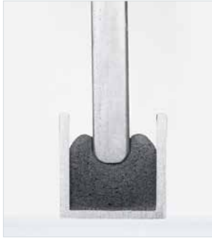
Querschnitt Polyurethanschäumraupe in Nut zu ca. 50 % verpresst
