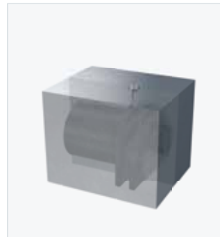
Zweiteiliges Formwerkzeug für die Herstellung einer Kabeltülle
