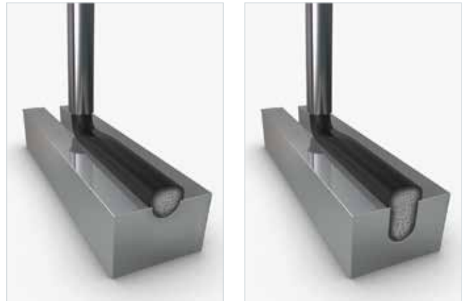
Die verschiedenen Reaktionsphasen des Dichtungsschaums in der zeitlichen Abfolge
