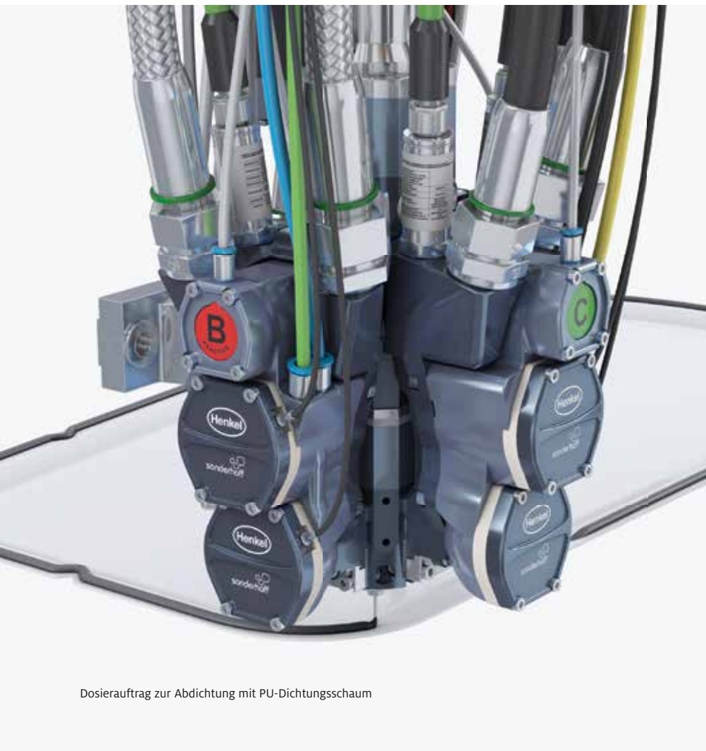
Mit PU-Schaum abgedichtete Kontur des Servicepanels der Waschmaschinenrückwand
