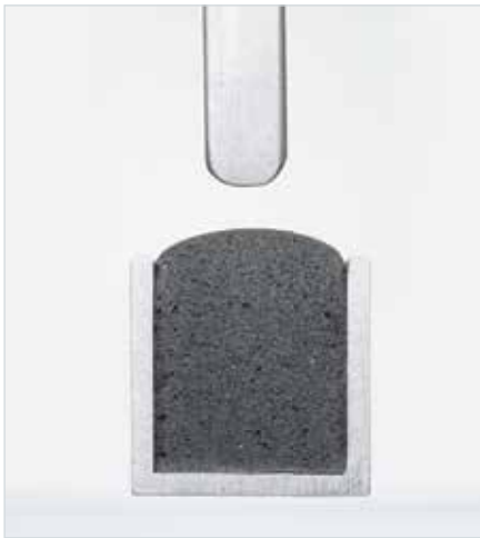
Querschnitt Polyurethanschaumraupe in Nut unverpresst
