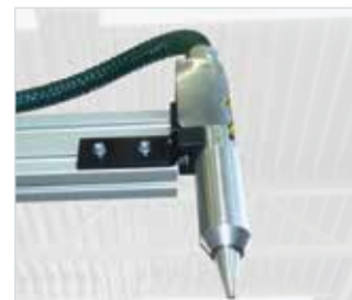
Die optional am CNC-Linearroboter montierte Plasmadüse trägt vor dem Dichtungsauftrag das Plasma auf.
