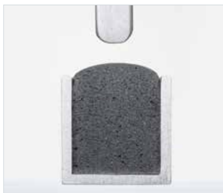
Querschnitt Polyurethanschaumraupe in Nut unverpresst
