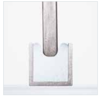
Querschnitt Silikonschaumraupe in Nut zu ca. 30 % verpresst
