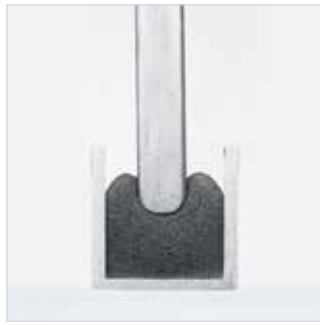
Querschnitt Polyurethanschaumraupe in Nut zu ca. 50 % verpresst
