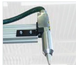
Die optional auf der Rückseite der CNC-Y-Achse montierte Plasmadüse trägt parallel zum Dichtungsauftrag auf den Kunststoffoberflächen des Bauteils in derselben Kontur das Plasma auf.
