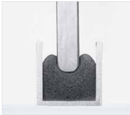
Querschnitt Polyurethanschäumraupe in Nut zu ca. 50 % verpresst
