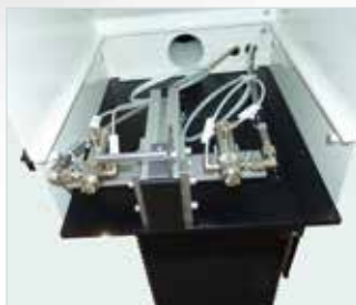
Die optional am Roboterarm montierte Primerdüse trägt parallel zum Dichtungsauftrag auf pulverbeschichteten oder Edelstahl-Oberflächen in derselben Kontur den Primer auf.
