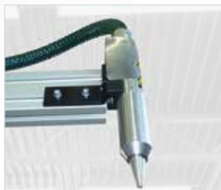
Die optional am Roboterarm montierte Plasmadüse trägt parallel zum Dichtungsauftrag auf den Kunststoffoberflächen des Bauteils in derselben Kontur das Plasma auf.
