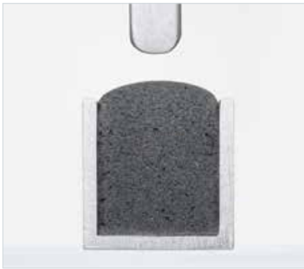
Querschnitt Polyurethanschäumraupe in Nut unverpresst
