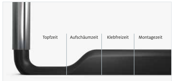
Die verschiedenen Reaktionsphasen des Dichtungsschaums in der zeitlichen Abfolge
