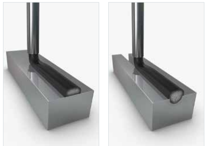
Der Dosierauftrag kann auf ebener Fläche oder in einer Nut erfolgen.
