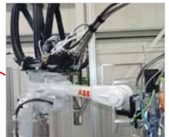
Der 6-Achs-Roboter führt den Mischkopf während der Dosierung konturgenau über das Bauteil.
