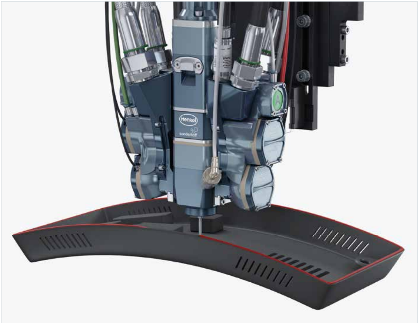
Auftrag der Kleberaupe auf dreidimensionalem Displaygehäuse mit Mischkopf MK 600
