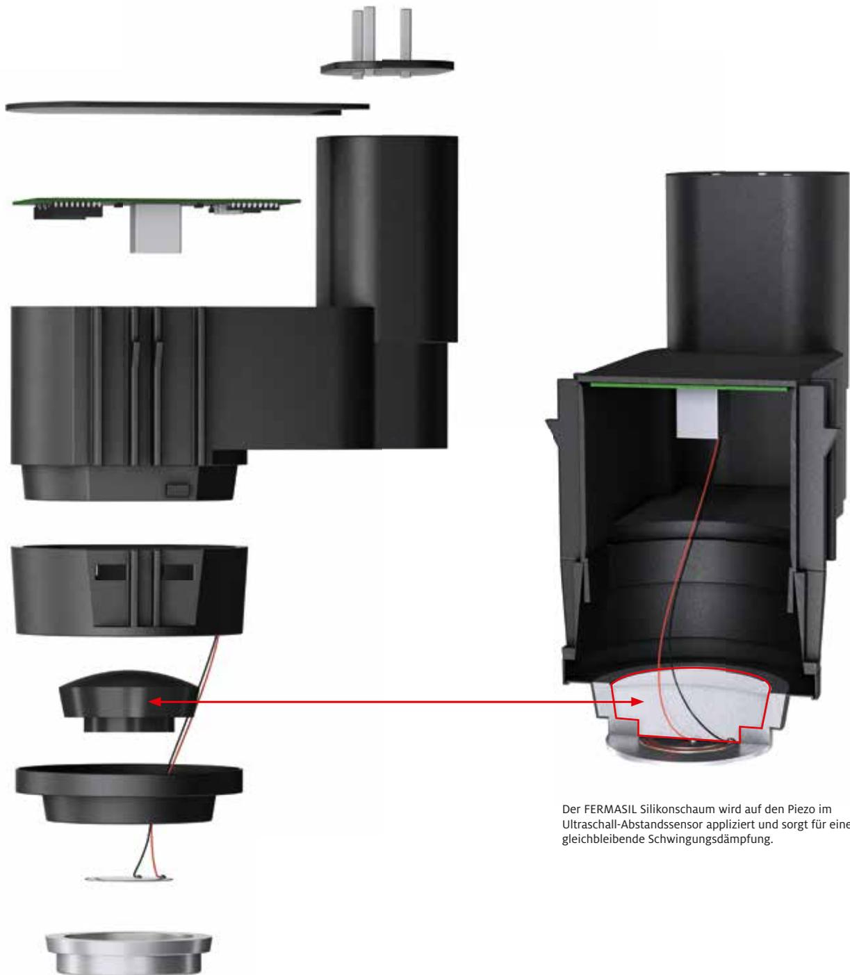
Der FERMASIL Silikonschaum wird auf den Piezo im Ultraschall-Abstandssensor appliziert und sorgt für eine gleichbleibende Schwingungsdämpfung.
