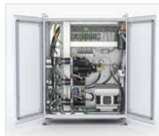
Der **Dosiermaschinenschrank** beinhaltet die Komponenten der Dosierperipherie wie z. B. die Dosierpumpen, die optionale Peltierkühlung und das Hochdruckaggregat zum Reinigen des Mischkopfes.
