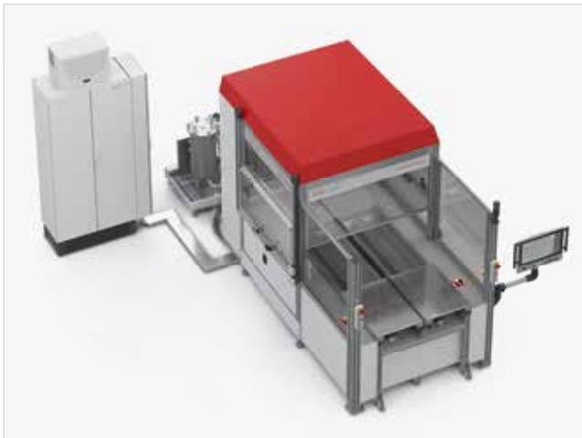
Alternative Referenzanlage der Dosierzelle SMART-L mit **Schiebetisch**. Zwei im Pendelbetrieb arbeitende Aufnahmeplatten ermöglichen das Bearbeiten der Teile auf einer Ebene. Damit können sehr kurze Taktzeiten und ein kontinuierlicher Betrieb gewährleistet werden.
