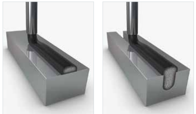
Die verschiedenen Reaktionsphasen des Dichtungsschaums in der zeitlichen Abfolge
