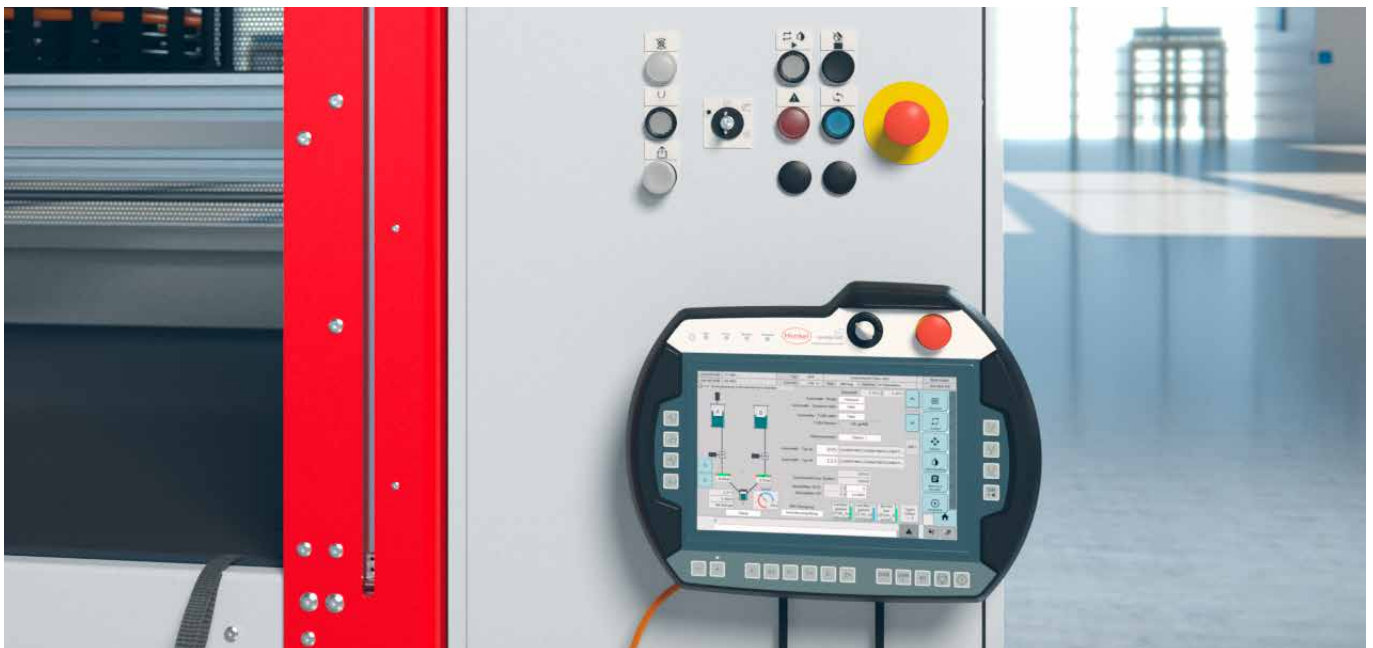
Mobilepanel MP 2 und oberhalb das Betriebsartenbedienfeld, z. B. Schlüsselschalter für die Betriebsartenvorwahl mit Auswahl für die Betriebsart Einrichten / Stand-by / Manuell / Automatik, Warnleuchten und NOT-HALT-Abschaltung (rot/gelb), Teil des bewährten SONDERHOFF-SAFETY-Sicherheitskonzepts.
