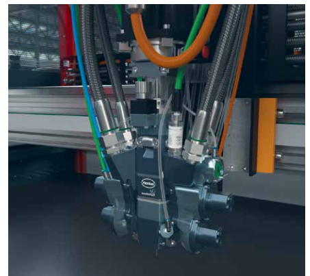
Standardausstattung: Präzisionsmischkopf MK 800 BASIC für 2 Komponenten, mit Hochdruckwasserspülung
