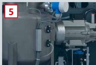
Kapazitive Sensoren für die Füllstandsregulierung
