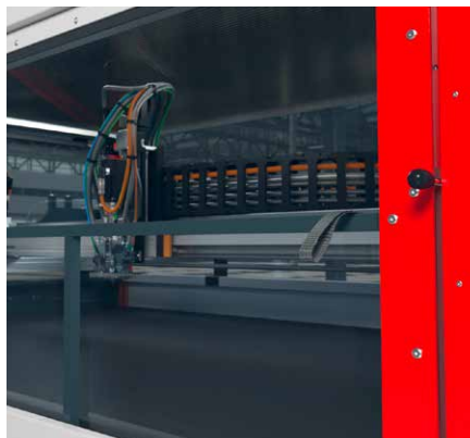
Halbgeöffnete Hubtür zeigt Präzisionsmischkopf MK 800 BASIC und Energiekette
