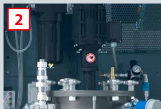
Rührwerk zur Homogenisierung der A-Komponente
