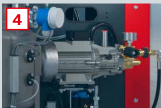
Hochdruckwasseraggregat für die effektive und ökologische Mischkopfspülung
