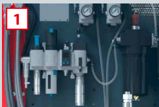
Druckluftanschluss, Trockner und Wartungseinheit
