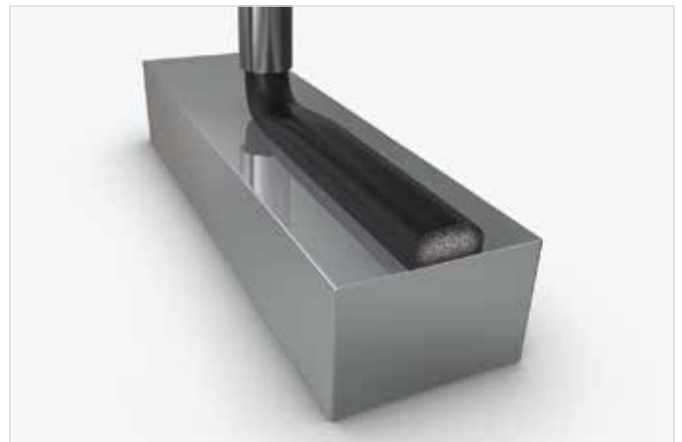
Der Prozessablauf zur Bildung einer Schaumdichtung
