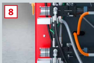
Präzisionszahnradpumpen mit Fördermenge 0,75 ccm/U (A-Komponente) und 0,3 ccm/U (B-Komponente)
