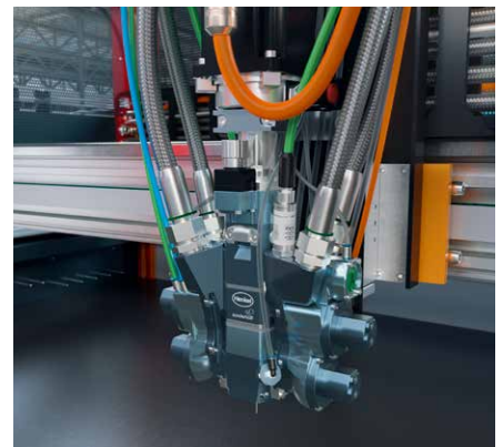
Standardausstattung: Präzisionsmischkopf MK 825 BASIC für 2 Komponenten, mit Hochdruckwasserspülung
