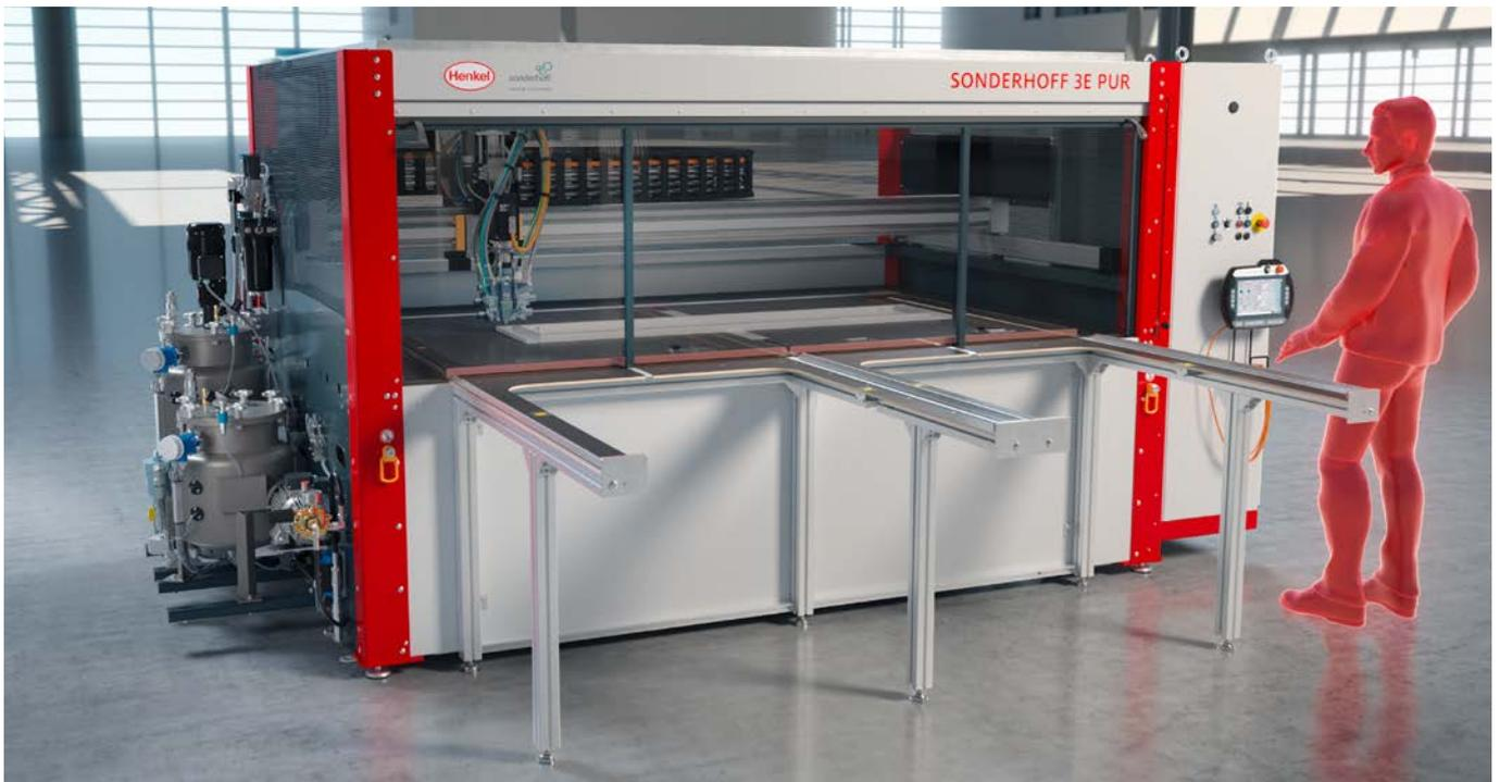
Für die Materialapplizierung auf übergroße Bauteile können die zwei Aufnahmeplatten zu einem großen Schiebetisch verbunden werden.
