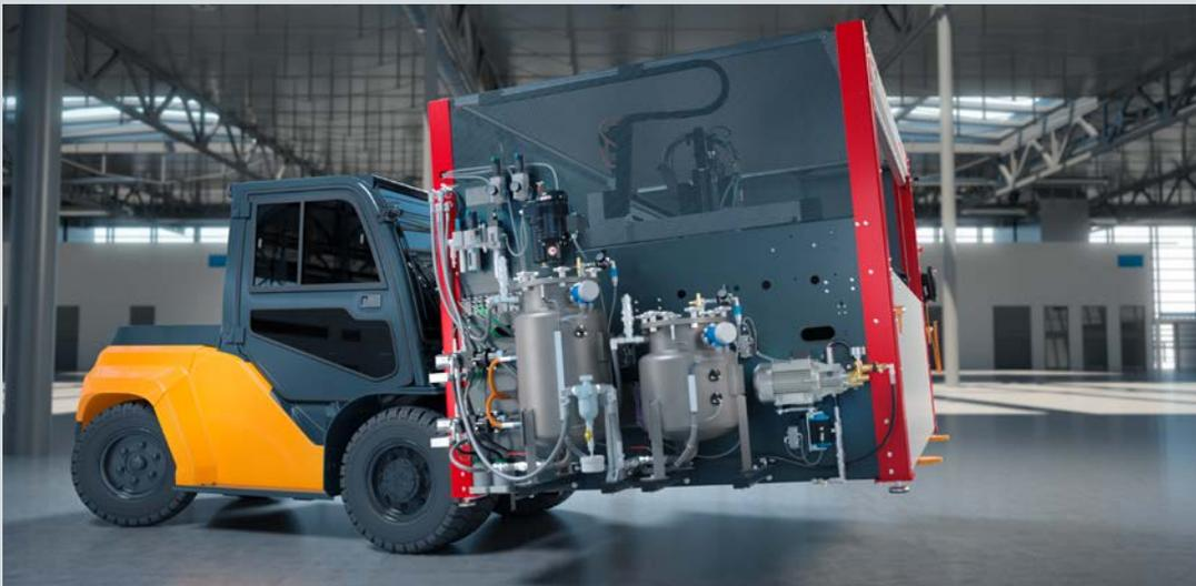
Die Dosierzelle wird aus dem Transportcontainer entnommen, aufgestellt und angeschlossen – place, plug & work. Alle Features sind auf einem Chassis angeordnet, so dass die Dosierzelle sehr einfach in der Produktion umgestellt werden kann.
