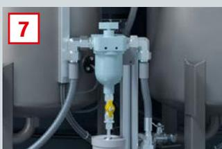
7 Plattenspalterfilter für die B-Komponente
