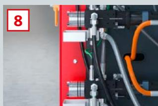
8 Präzisionszahnradpumpen mit Förder-
