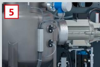
5 Kapazitive Sensoren für die Füllstands-
