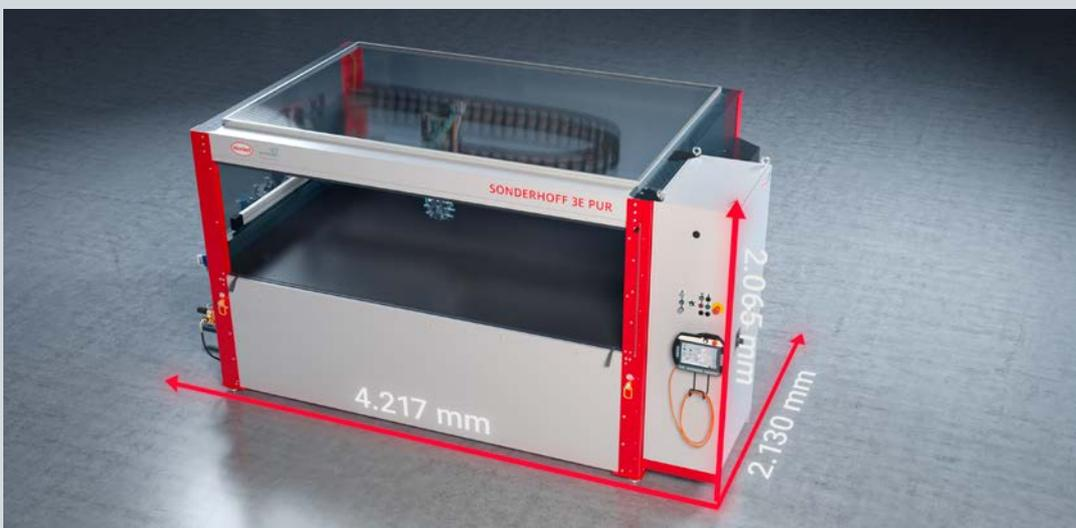
Die als Fertigungsinsel flexibel einsetzbare Dosierzelle benötigt mit einer Aufstellungsfläche von ca. 9 qm sehr wenig Platzbedarf.
