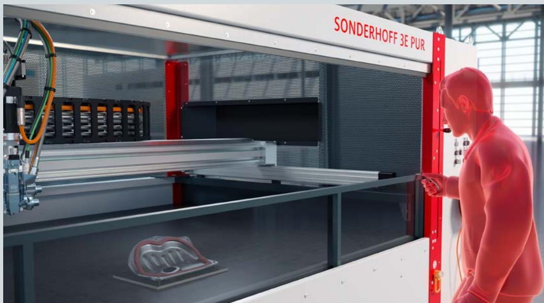
Zur Entnahme eines oder mehrerer Bauteile nach dem Dosiervorgang öffnet der Maschinenbediener die Hubtür mit der dort angebrachten Handschlaufe oder über den Handhebel.
