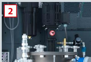
2 Rührwerk zur Homogenisierung der
