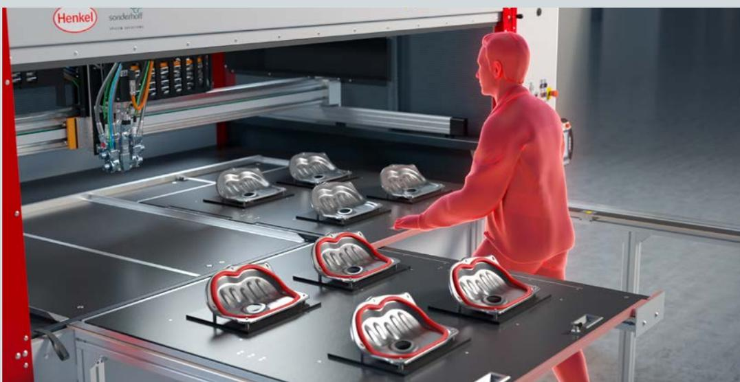
Nach dem Dosierauftrag öffnet der Maschinenbediener die Hubtür und zieht den Schiebetisch mit den fertigen Bauteilen zur Entnahme aus dem Arbeitsbereich heraus.
