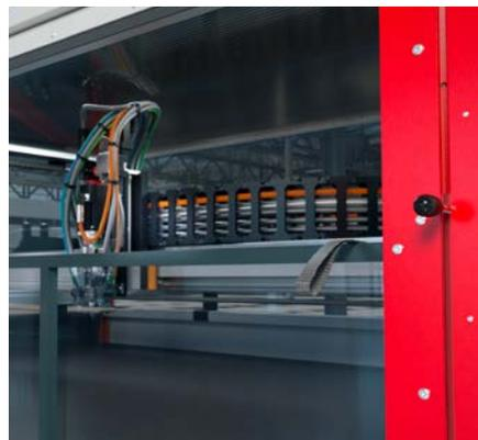
Halbgeöffnete Hubtür zeigt Präzisionsmischkopf MK 825 BASIC und Energiekette
