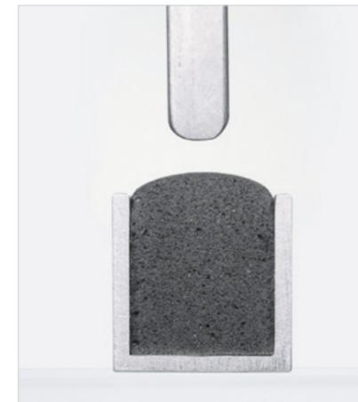
Querschnitt Polyurethanschaumraupe in Nut unverpresst
