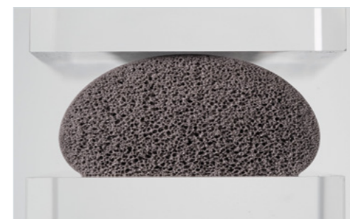
Die unverpresste Polyurethan-Schaumdichtung vor dem Einbau.
