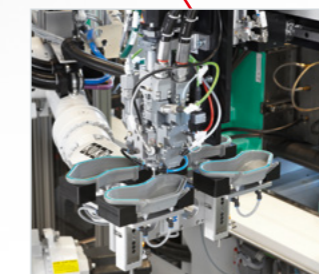
Der 6-Achs-Roboter führt das Bauteil unter dem Mischkopf für den konturgenauen Dosierauftrag der Schaumdichtung.
