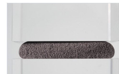
Durch das Verpressen der Schaumdichtung wird die Dichtigkeit im Einbauzustand erreicht.
