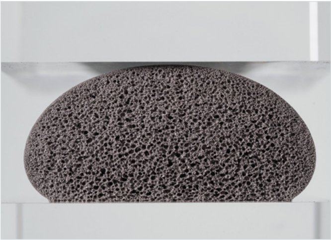
Querschnitt Polyurethanschaumraupe unverpresst
