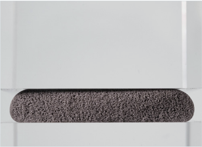
Querschnitt Polyurethanschaumraupe zu 50 % verpresst
