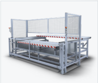
Wechsel- / Schiebetisch WT 2-LEVEL Zwei im Pendelbetrieb arbeitende Aufnahmeplatten in zwei Ebenen
