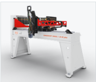
Optional: Hocheffizienter 3-Achs-Linearroboter LR-HE plus für die präzise Führung von Mischköpfen zum Auftrag polymerer Reaktionswerkstoffe. Der Omega Zahnriemenantrieb ermöglicht hohe Auftragsgeschwindigkeiten bei Bauteilen mit mittleren und großen Radien.
