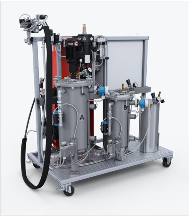
Misch- und Dosiermaschine DM 70 COMPACT mit Materialdruckbehältern (24 l oder 44 l), ausgestattet mit Minimum-Füllstandsensoren und zusätzlichem Druckbehälter für Mischkopf-Reinigungsmittel
