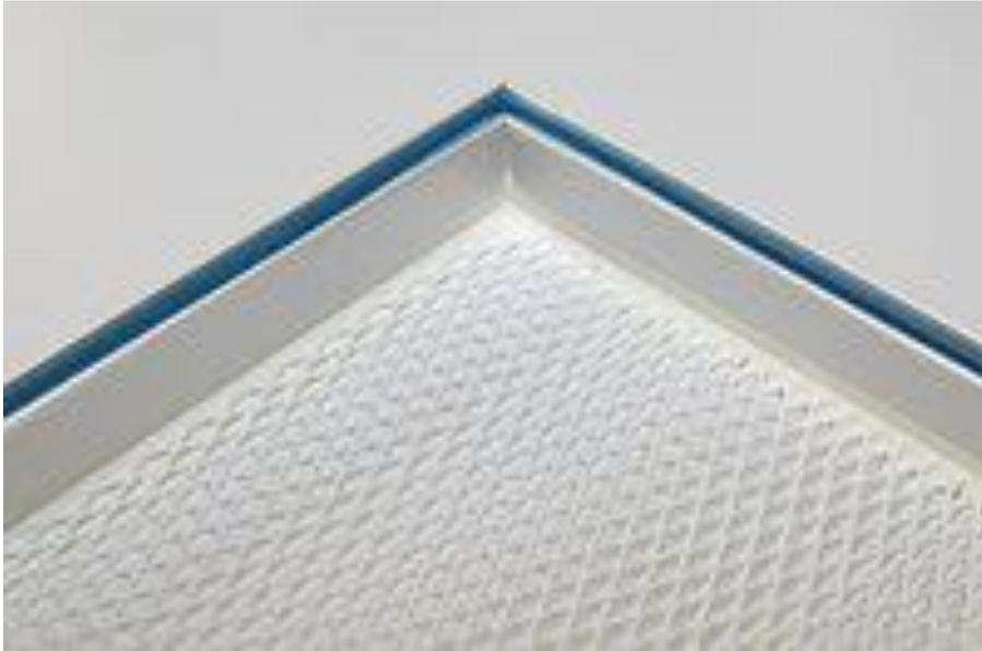
Die Filterrahmen sind mit PU Vergussgel im Nut-/Federprinzip luftdicht abgedichtet und die Filter im Rahmen mit Klebdichtstoff verklebt.
