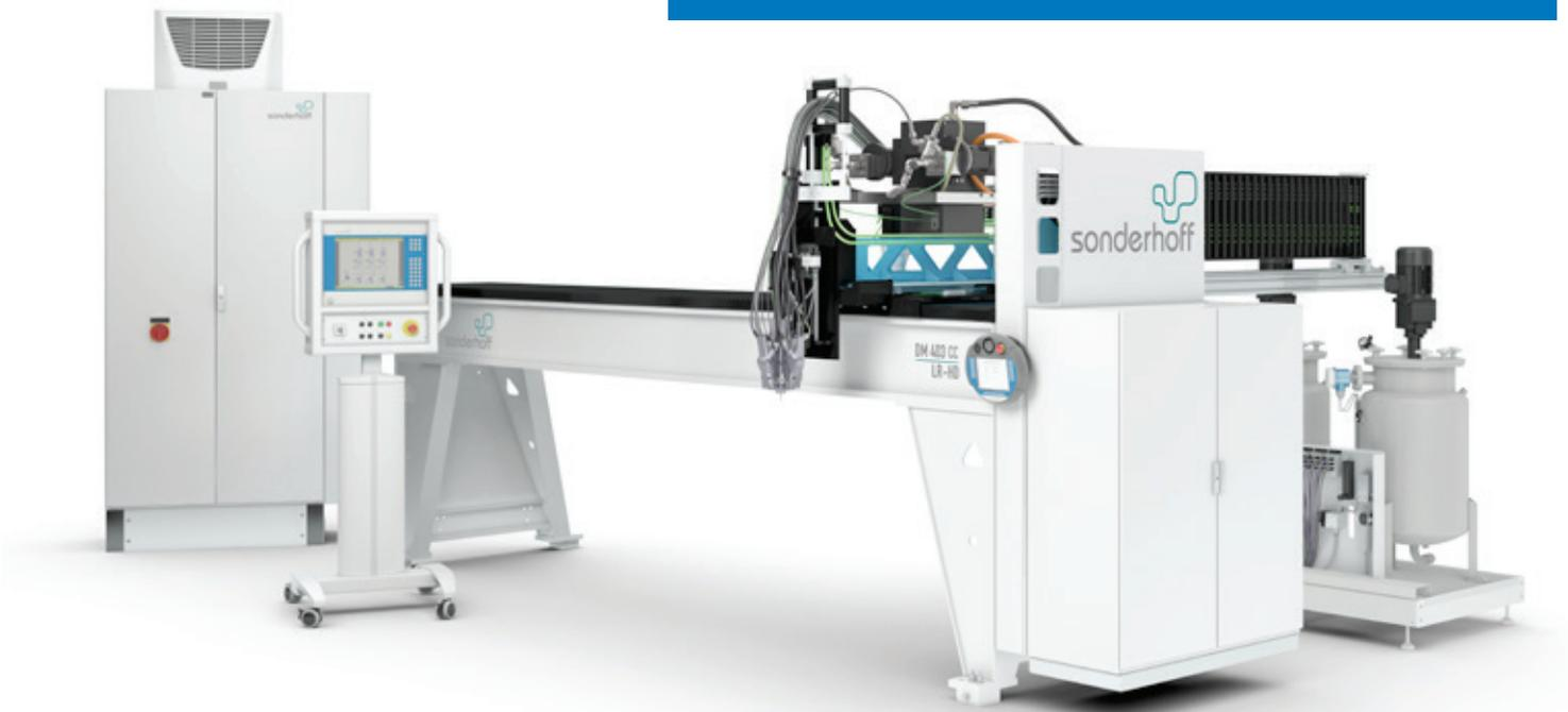
Die patentierte Dosiertechnologie der neuen Misch- und Dosieranlage DM 402 / 403 CC erzeugt einen Dichtungsschaum, der direkt nach der Dosierung fast vollständig sein ausreagiertes Volumen zeigt – ein großer Vorteil für die prozessnahe Qualitätskontrolle. Der Applikationsprozess selbst folgt dem bekannten FIPFG-Verfahren (Formed In-Place Foam Gasket), das in vielen Branchen Produktionsstandard ist.
