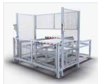
Wechsel- / Schiebetisch Zwei im Pendelbetrieb arbeitende Aufnahmeplatten in einer Ebene
