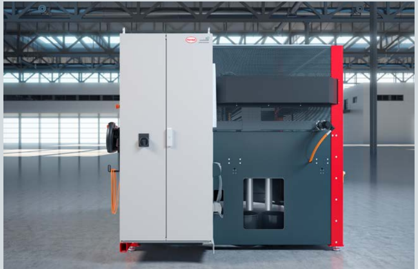
Stirnseite (rechts) der Dosierzelle SONDERHOFF 3E SIL zeigt den am Zellenchassis befestigten Schaltschrank zur Steuerung der Dosiermaschine, links davon die Halterung für das Mobilepanel MP 2 und rechts davon die Öffnung zur Entnahme der Füllschuss- und Spülwasserbehälter
