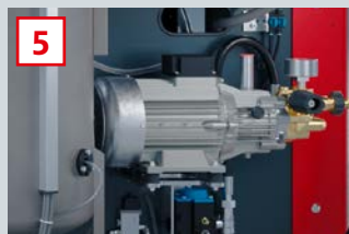
Hochdruckwasseraggregat für die effektive und ökologische Mischkopfspülung
