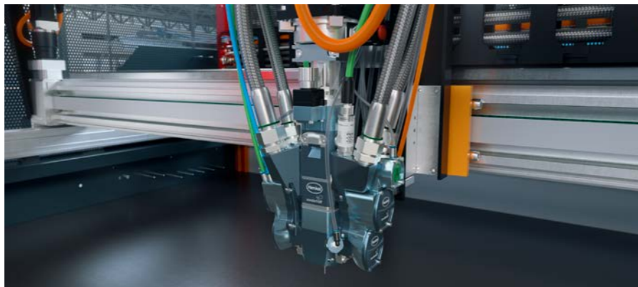
Standardausstattung: Präzisionsmischkopf MK 800/825 PLUS für 2 Komponenten mit Hochdruckwasserspülung.
