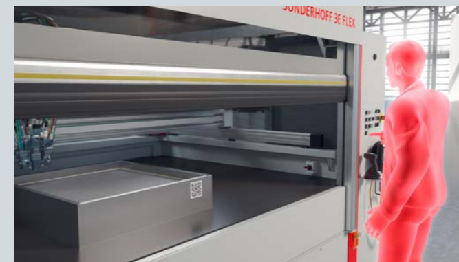
Zur Entnahme eines oder mehrerer Bauteile nach dem Dosiervorgang öffnet sich das Schnellaufstor automatisch oder das Bedienpersonal öffnet es per Tastendruck.
