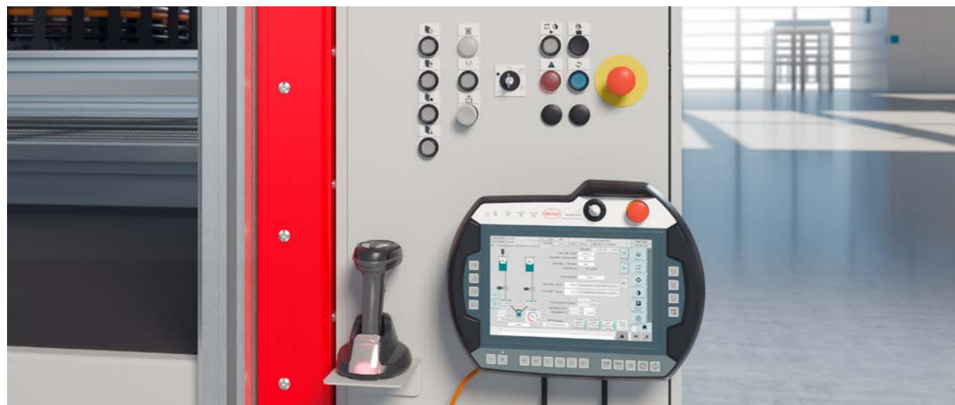
Mobilepanel MP 2 und oberhalb das Betriebsartenbedienfeld, z. B. Schlüsselschalter für die Betriebsartenvorwahl mit Auswahl für die Betriebsart Einrichten / Stand-by / Manuell / Automatik, Warnleuchten und NOT-HALT-Abschaltung, Teil des bewährten SONDERHOFF-SAFETY-Sicherheitskonzepts.
