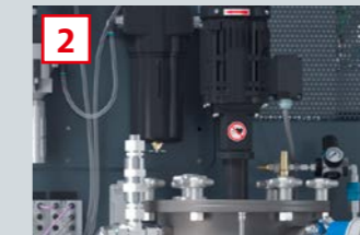
Rührwerk zur Homogenisierung der A-Komponente
