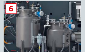
Materialdruckbehälter mit optimierten Größen für asymmetrische (PUR-Systeme) oder symmetrische (SIL-Systeme) Mischungsverhältnisse
