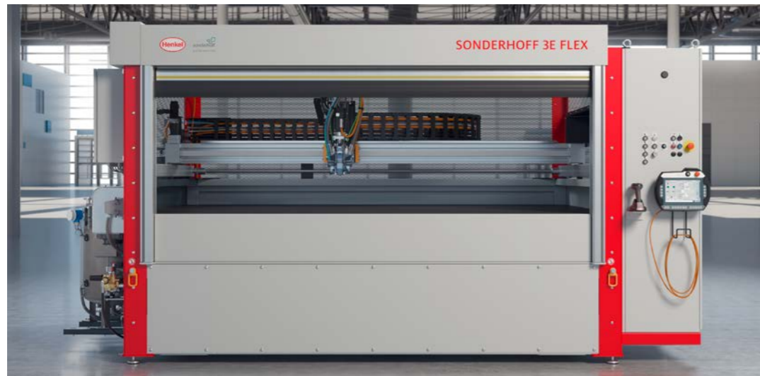
Vorderseite der 3E FLEX mit oberer, abnehmbarer Abdeckplatte. Höhe der Tischplatte 1.000 mm.
