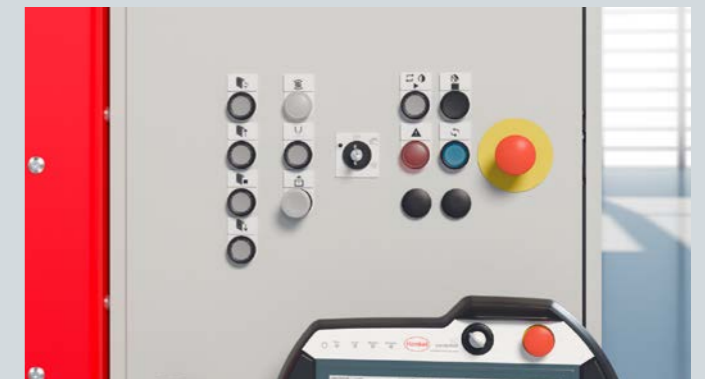
Betriebsartenbedienfeld mit Warnleuchten, Schlüsselschalter zur Vorwahl der Betriebsart, Bedientasten für Schnellaufstor und NOT-HALT Abschaltung mit bewährtem Sonderhoff-SAFETY Sicherheitskonzept.
