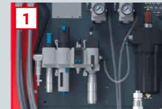
Druckluftanschluss, Trockner und Wartungseinheit
