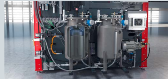
Druckluftpolster wirkt auf Materialoberfläche
